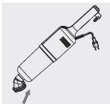
Присоедините к всасывающему отверстию пылесоса малую насадку-щетку для мягкой мебели или узкую щелевую насадку для уборки труднодоступных мест. Насадка для мягкой мебели может использоваться для очистки мебели, одежды, углов стен.
