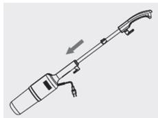
2. Вставьте удлинительную трубку с ручкой в отверстие в верхней части корпуса пылесоса. Трубку можно поворачивать вправо или влево, но не
