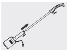
Чтобы отсоединить удлинительную трубку, нажмите на кнопку снятия удлинительной трубки.
