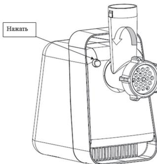
1. Одной рукой возьмитесь за корпус мясорубки и большим пальцем нажмите на кнопку для установки и снятия камеры мясорубки на корпусе, другой рукой возьмите камеру мясорубки и вставьте ее в отверстие для установки, повернув против часовой стрелки. Затем отпустите кнопку. Слегка покачайте камеру мясорубки, чтобы убедиться, что она надежно держится.
